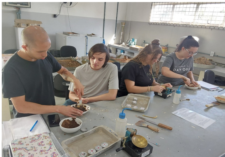
Figura 1 – Estudantes realizando ensaio para determinação de Limite de Liquidez do Solo
