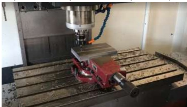
Figura 3 – Usinagem CNC de peças do projeto.
