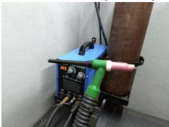
Figura 6 – Processo TIG utilizado na montagem e soldagem do equipamento.
