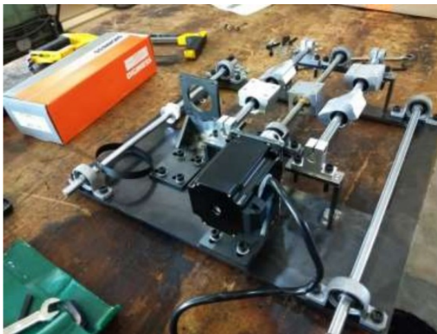
Figura 9 – Instalação de componentes eletromecânicos.
