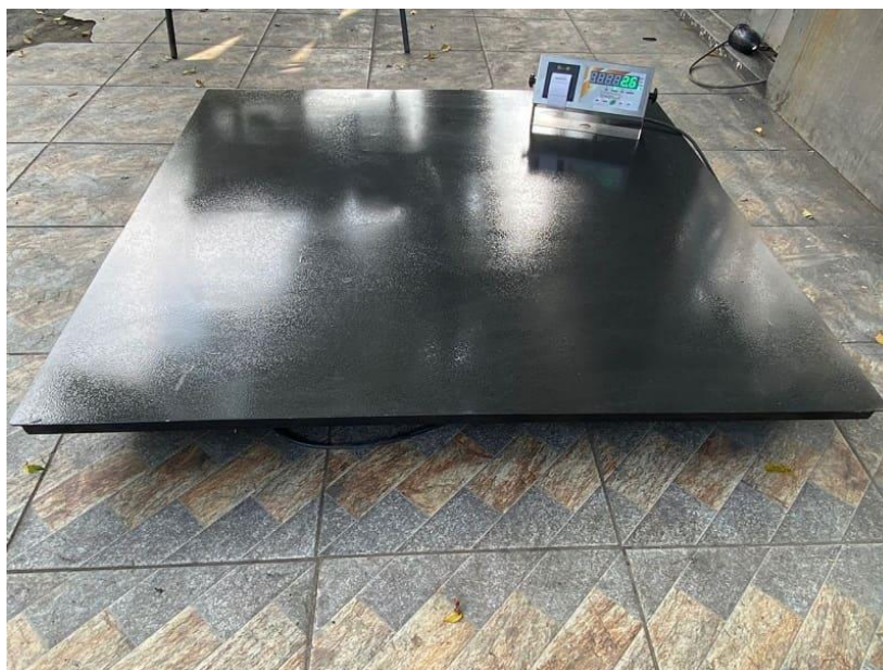
Figura 5 - Balança industrial de plataforma.
