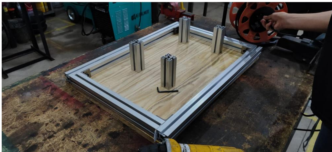
Figura 2 – base estrutural de alumínio (perfil retangular)
