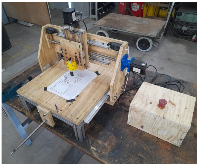
Figura 7 – montagem completa da máquina CNC (partes mecânicas e elétricas)
