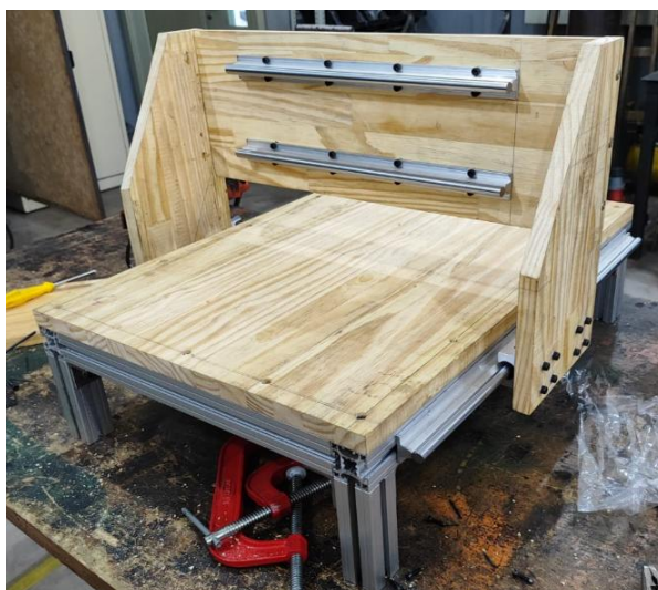
Figura 4 – montagem da estrutura e guias lineares
