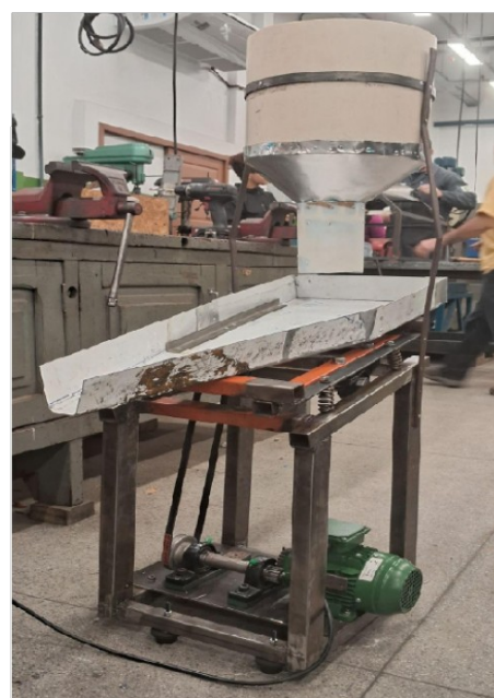
Figura 2 – Projeto conceitual e construção de um alimentador para animais.
