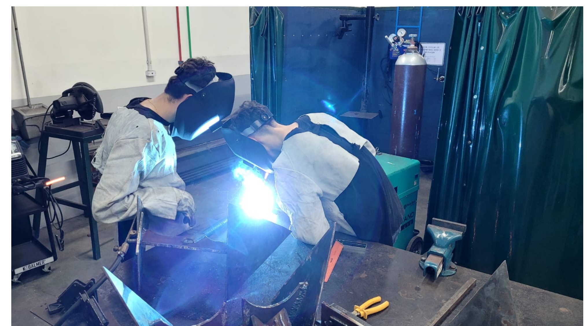
Figura 1 - Membros do projeto realizando operação de soldagem em uma das âncoras.
