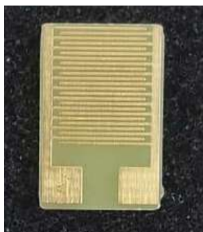
Figura 1 - PCB de FR-4 e trilhas de ouro, fabricada para a deposição dos filmes de aerogéis nos sensores.
