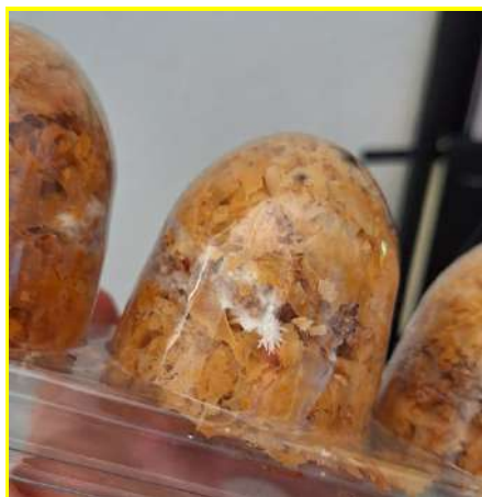
Figura 1- Teste de crescimento do micélio em molde.
