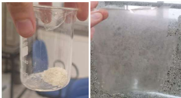
Figura 1 e 2- Carragena obtida por isopropanol e pré tratamento alcalino respectivamente
