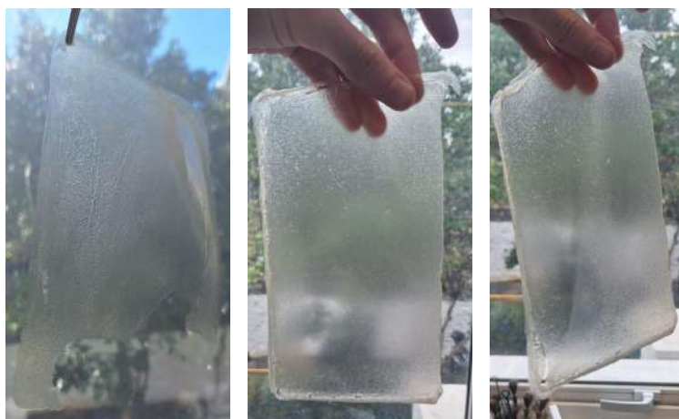
Figura 3,4 e 5 - Biofilme de carragena com 1,3 e 5% de concentração de glicerol respectivamente
