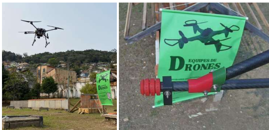
Figura 4- Inspeção do banner com trem de pouso em estágio normal.
