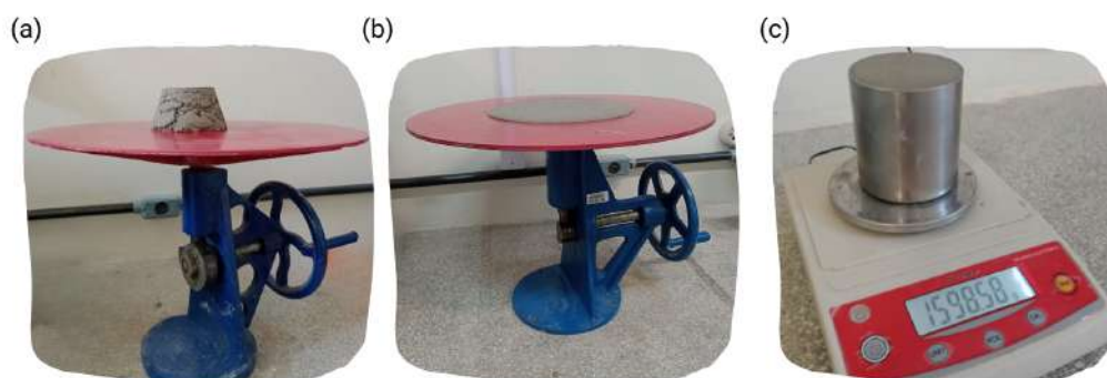
Figura 1- (a) e (b) Ensaio de índice de consistência e (c) Ensaio de teor de ar incorporado
