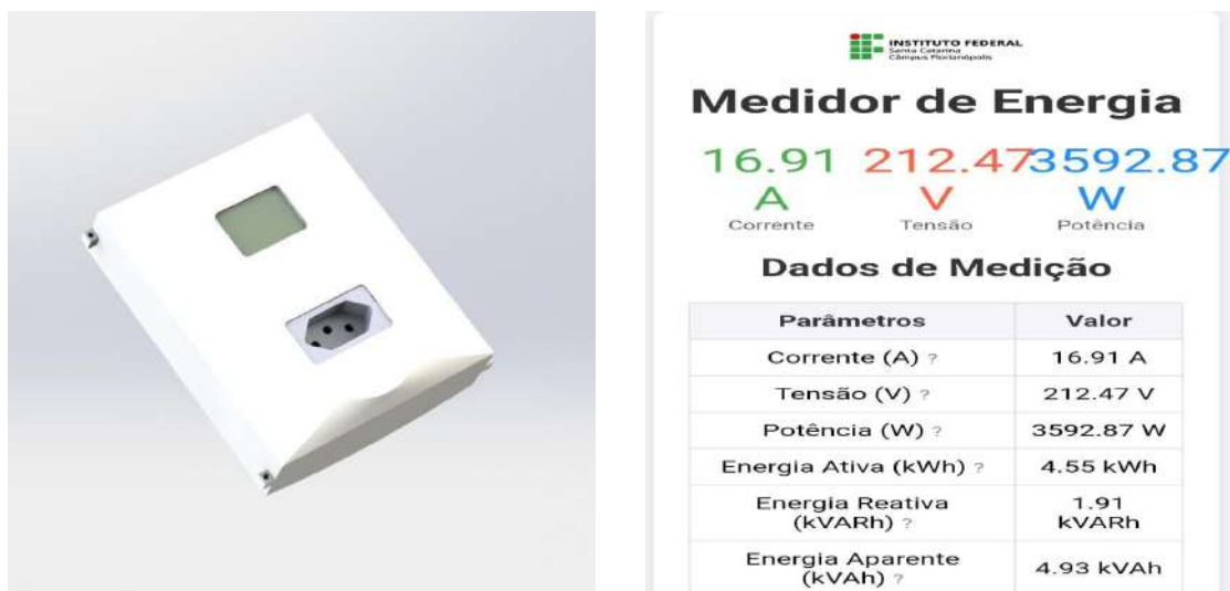
Figura 2 – Modelo 3D do medidor e interface web.
