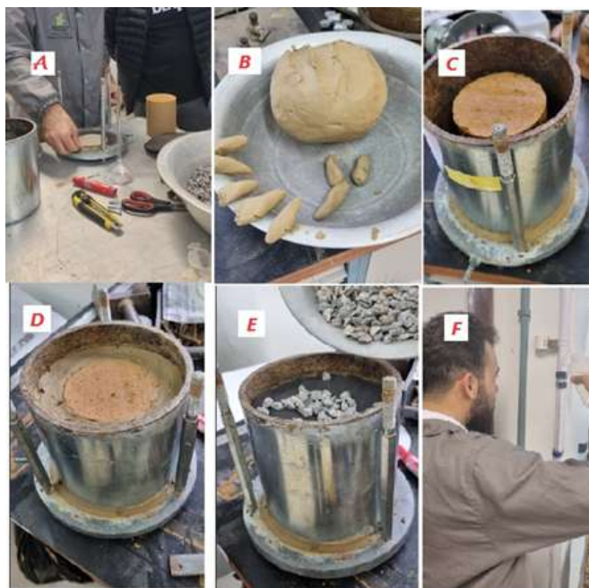
Figura 1: Montagem do experimento de permeabilidade
