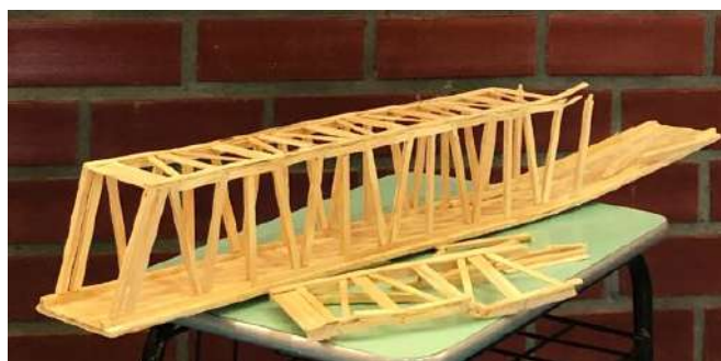
Figura 1- Treliça após rompimento.
