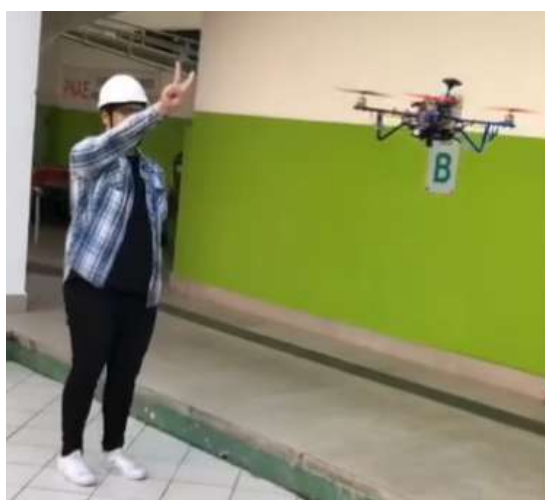
Figura 3 - Operador controlando drone por gestos.
