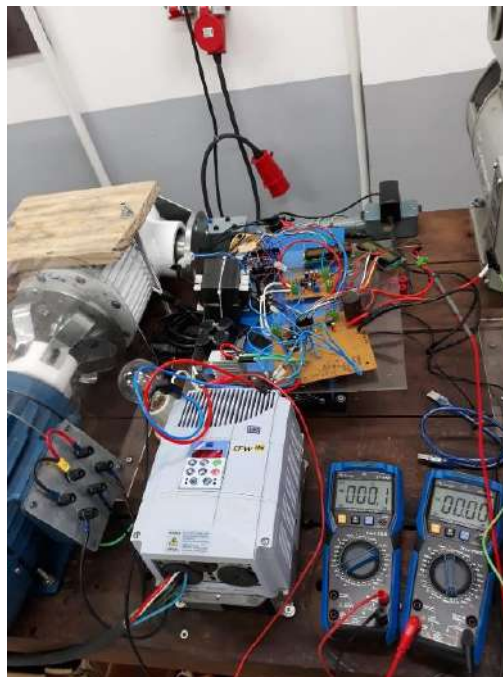
Figura 03: bancada de ensaio do PMSG de 1KW com boost MPPT HCC .
