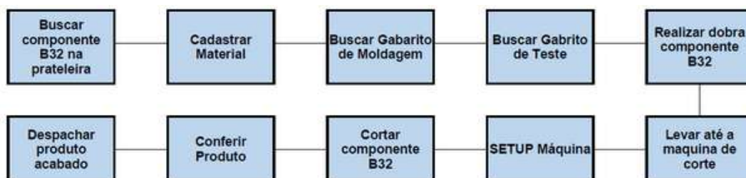
Figura 2. Fluxo de produção do componente
