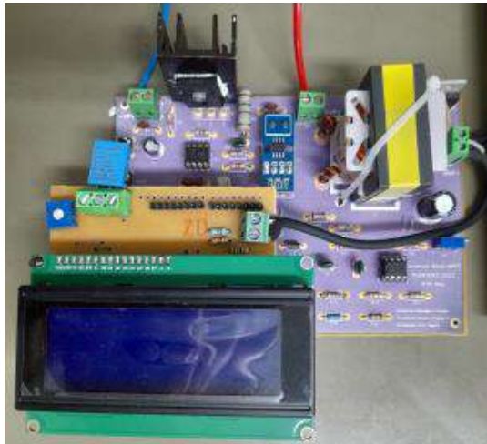
Figura 3: Conversor Boost finalizado.
