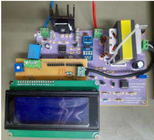
Figura 3: Conversor Boost finalizado.
