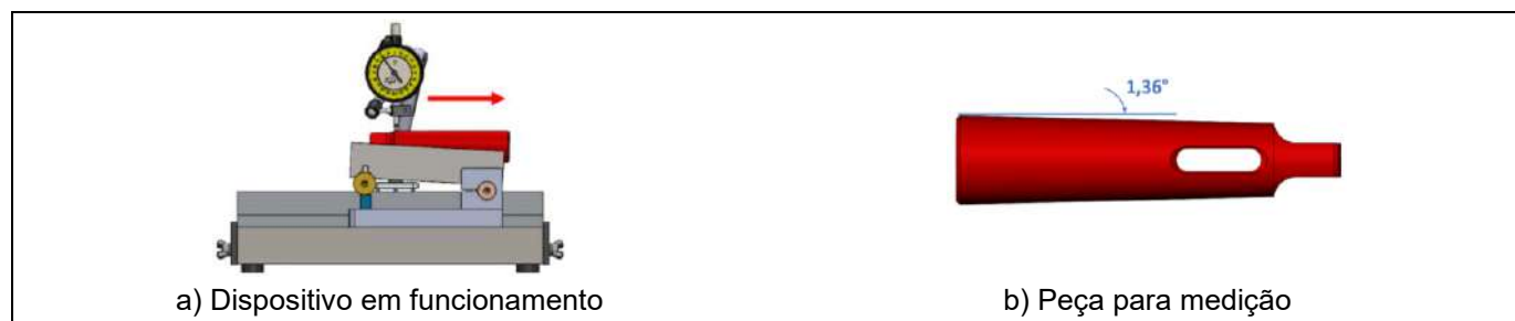
Figura 2: Dispositivo em operação realizando a medição de um cone Morse.
