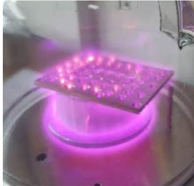
Fig. 2: Fotografia do plasma com efeito de catodo oco
