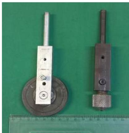
Figura 1. Dispositivo de montagem e faca industrial (à esquerda)
