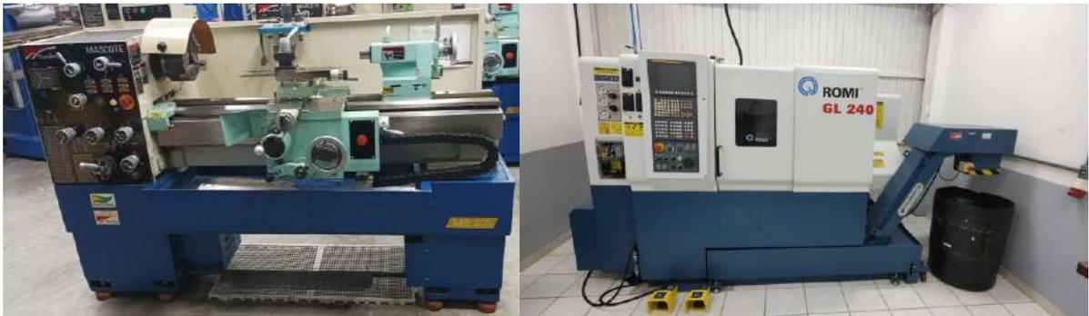
Figura 2: Equipamentos utilizados: (a) Torno convencional Nardini Mascote, (b) Torno CNC ROMI GL 240. Fonte: os autores (2023).
