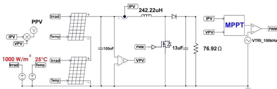
Figura 1 - Conversor *Boost* com entrada de arranjo fotovoltaico.
