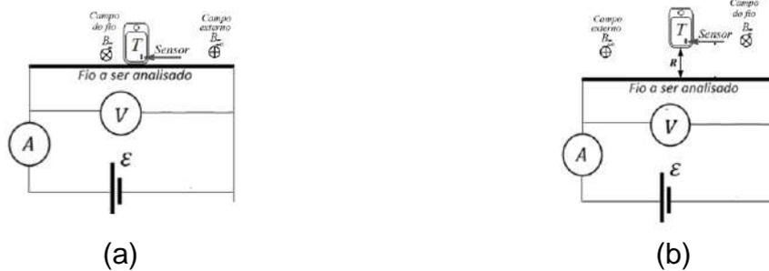
Figura 1: Circuito esquemático utilizado nos experimentos para a determinação da: (a) posição  $R_o$  do sensor *Hall* e (b) da velocidade de deriva.
