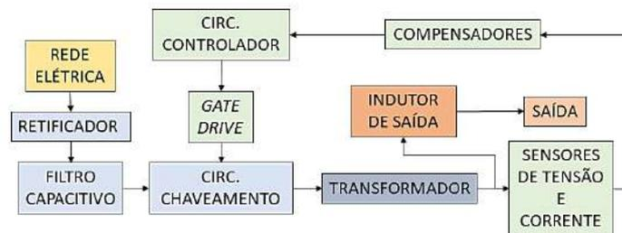
Figura 1: Diagrama de construção do protótipo
