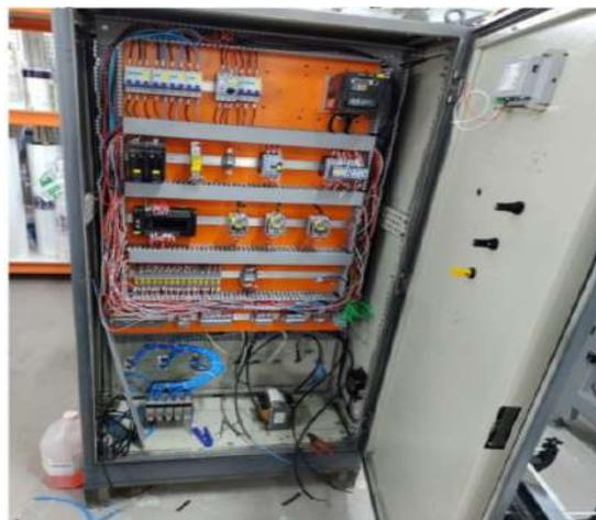
Figura 1 – Montagem do painel da bancada de testes
