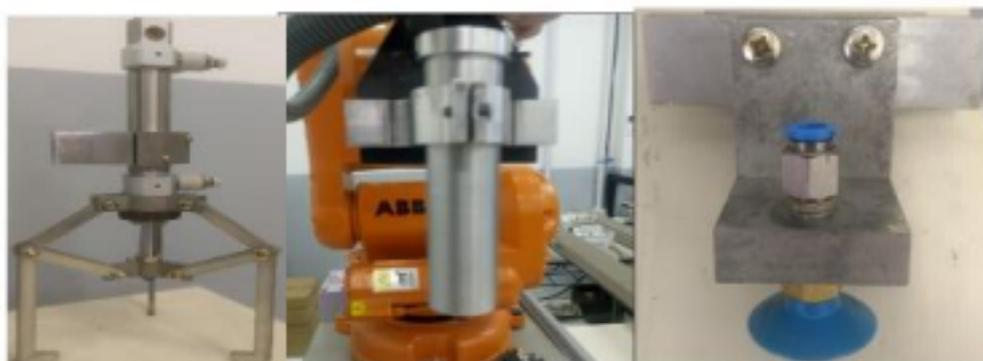
Figura 3: Da esquerda para a direita: garra de três dedos, suporte de pincel atômico e ventosa
