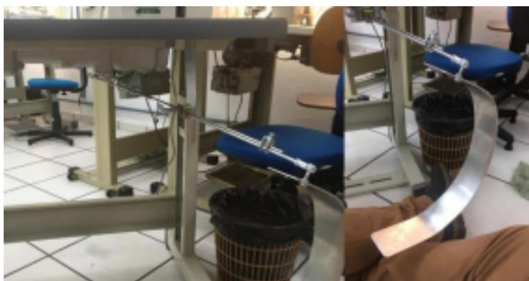
Figura 1 – Montagem do dispositivo na máquina de costura
