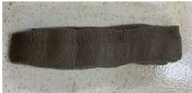
Figura 3 - Extrusão manual de filete da argamassa
