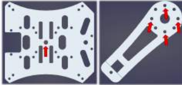
Figura 1 – Centerplate inferior e braço (da esquerda para direita)
