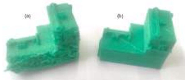
Figura 2 – Peça impressa à (a) 215 °C e (b) 230 °C.
