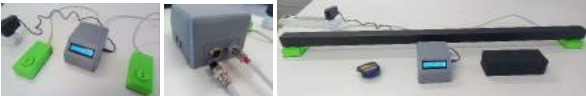
Figura 3 - (a) Projeto construído, (b) conectores utilizados e (c) dispositivo montado para um experimento.
