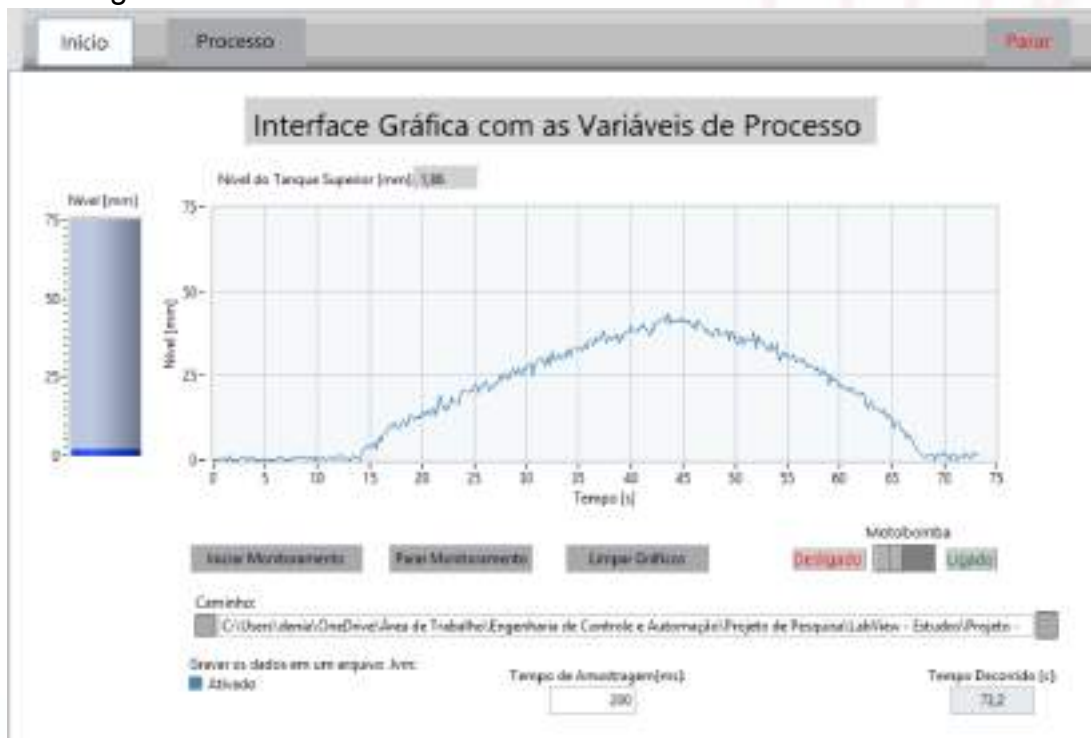
Figura 2 – Tela de monitoramento da variável de nível no LabVIEW
