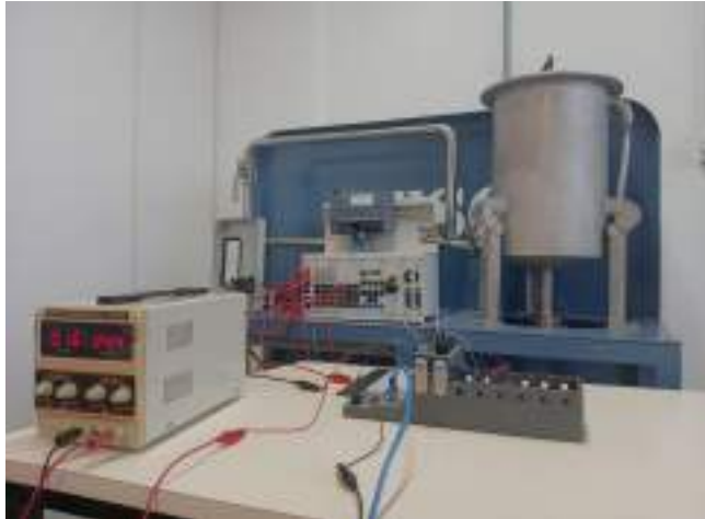
Figura 3 – Interligação da DAQ com a Planta Didática
