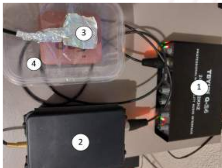
Figura 2 – Esquema de testes: 1, a interface de áudio; 2, caixa hermética do pré-amplificador; 3, o sensor piezoelétrico blindado; e 4, recipiente com caixa de som
