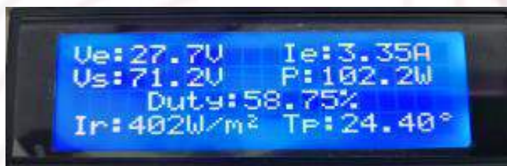
Figura 4 – Dados do MPP no conversor real com irradiância de 402 W/m 2
