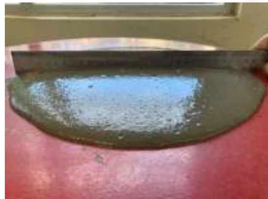
Figura 2 - Altura (a) e espalhamento (b) durante ensaio de consistência
