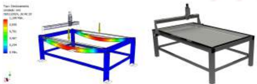
Figura 1 – Análise estrutural e vista isométrica
