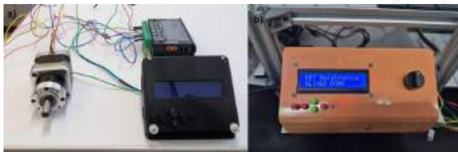
Figura 2 – Controle com arduino uno em (a) e controle com a ESP32 em (b)
