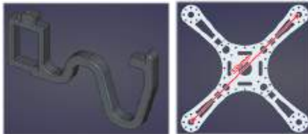
Figura 2 – Trem de pouso e indicação de distância de 330 mm entre rotores opostos.
