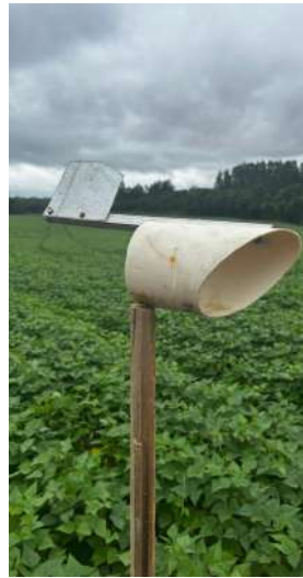
Figura 1 – Coletor de esporos a campo.
