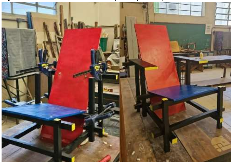
Figura 2 - Fixação do assento e encosto (à esquerda) e acabamento final (à direita)
