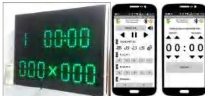
Figura 2: À esquerda Foto do placar eletrônico poliesportivo. À direita telas do aplicativo desenvolvido
