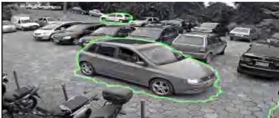
Figura 1: Algoritmo de detecção de veículos em movimento, indicados pelo contorno verde.
