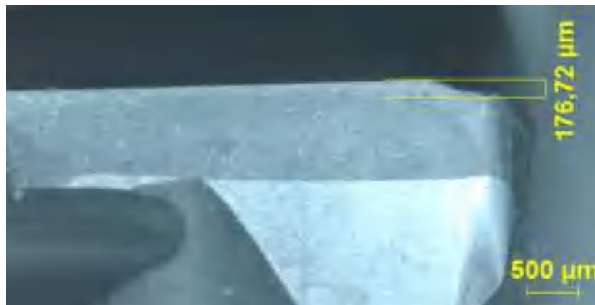
Figura 6 – Desgaste de flanco máximo VB_{\max} :
