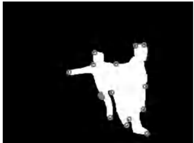
Figura 2 – Imagem da subtração de fundo com todos os pontos candidatos.
