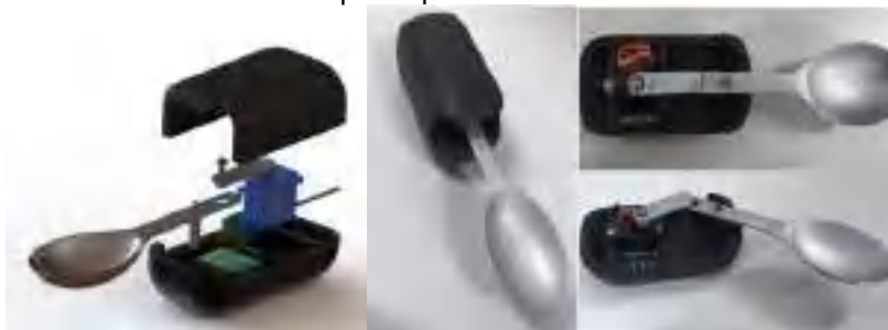
Figura 04 – Modelo Mecânico Colher SolidWorks e protótipo final.
