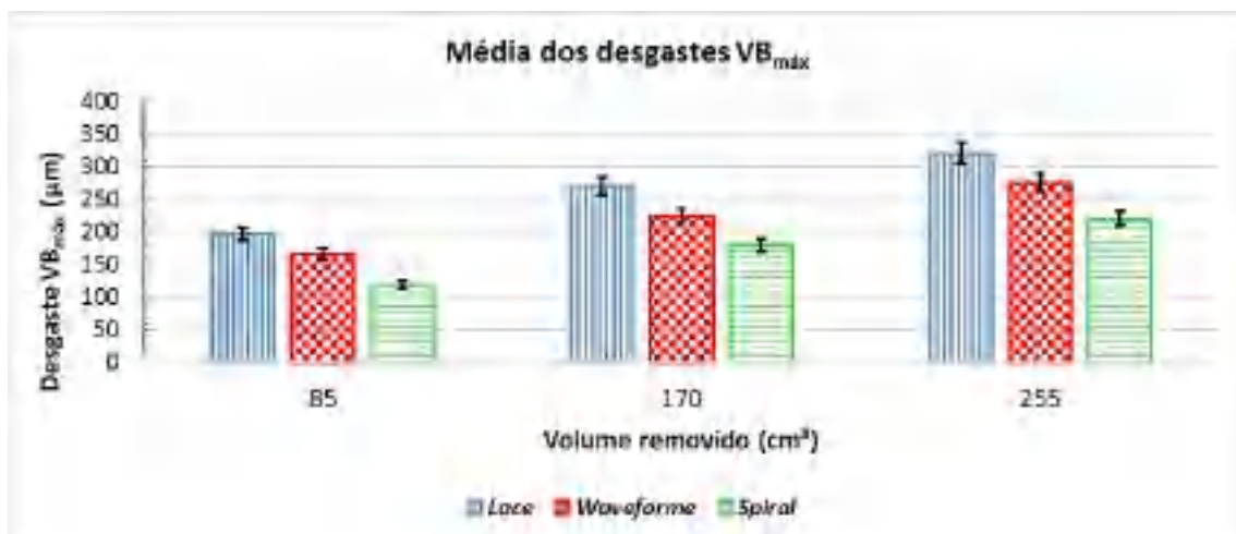
Figura 4 – Desgaste de flanco VB_{máx} para três estratégias de usinagem
