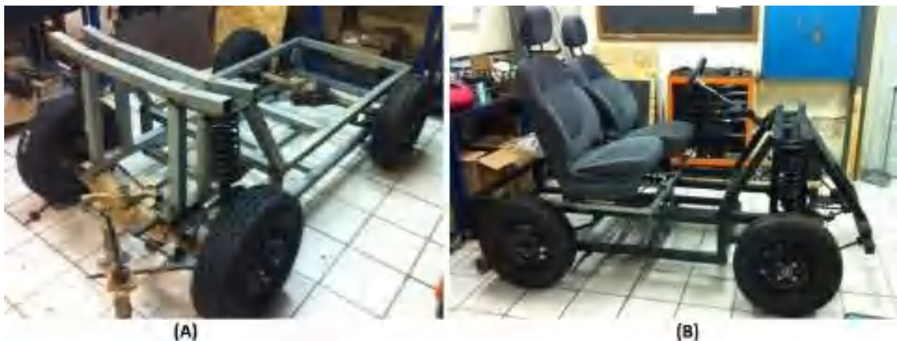
Figura 2: (A) Chassi do Veículo elétrico construído a partir de dois eixos usados; e (B) Estágio atual do EV-IFSC
