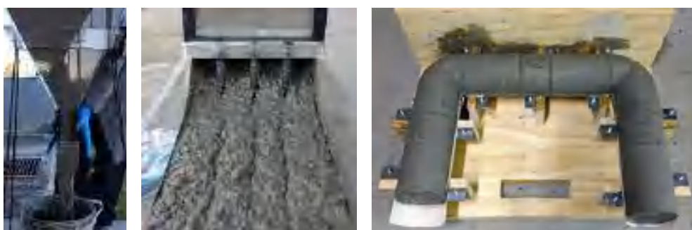
Figura 2 - Ensaio para o funil V (CAA com fluidez ideal), caixa L (CAA com princípio de segregação) e tubo U.
