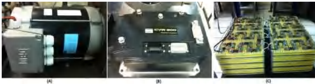
Figura 1: (A) Motor Elétrico utilizado no projeto; (B) Inversor de Frequência Automotivo CWF300; e (C) Bando de Baterias de Lítio.
