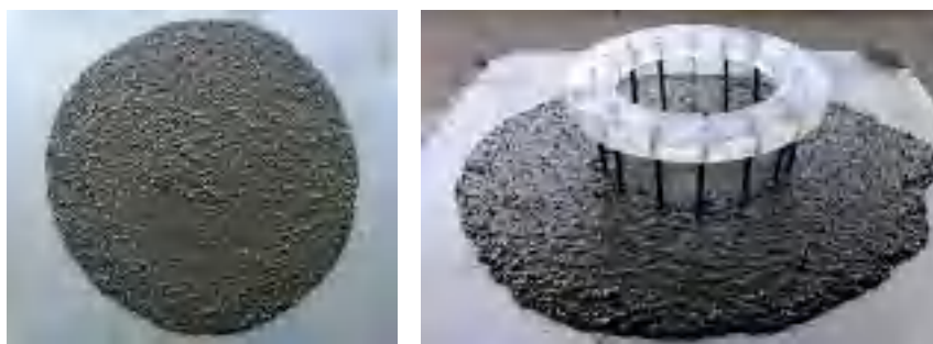
Figura 1 - Ensaio de espalhamento, com fluidez adequada, e do anel J com habilidade passante dentro do esperado.
