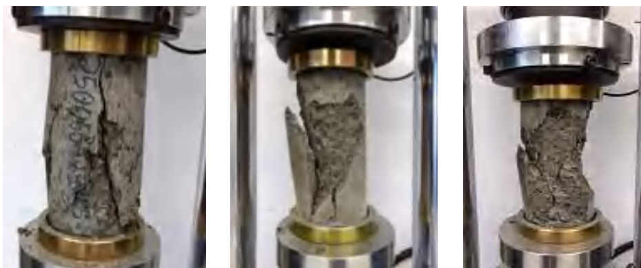
Figura 3 - Corpos-de-prova do CAA após o ensaio de resistência mecânica.
