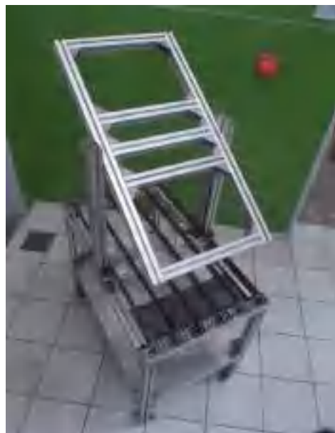
Figura 4- Plataforma de Posicionamento para Corte e Soldagem de Metais
