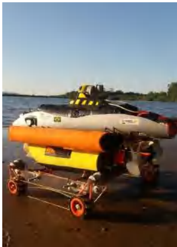
Figura 2 – Veículo .R.O.U.V. pronto para a utilização em ambiente natural, porém com restrições de distância e profundidade.
