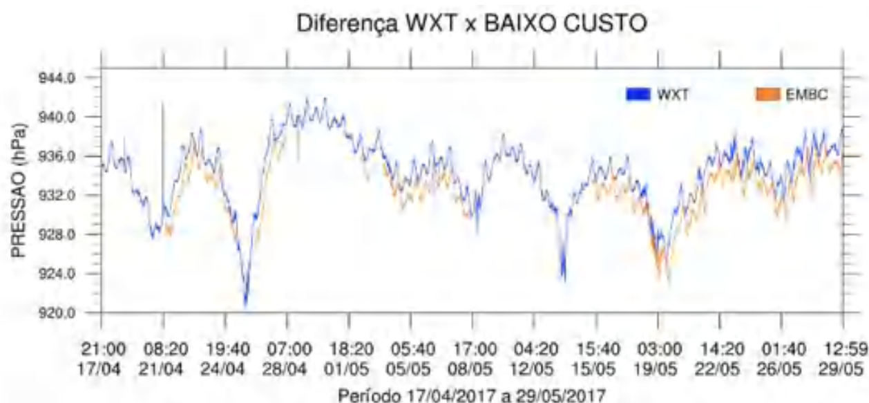
Gráfico 2: Comparação da pressão atmosférica em Chapecó entre a estação profissional e a estação de baixo custo. Fonte: Autor
