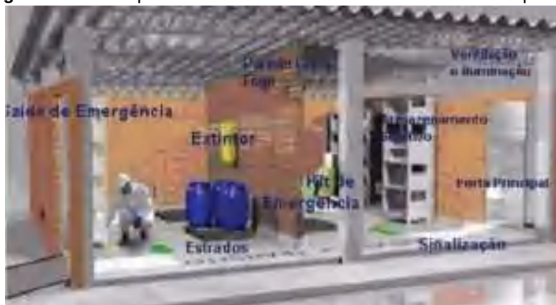
Figura 04 – Exemplo de local de armazenamento de resíduos especiais
