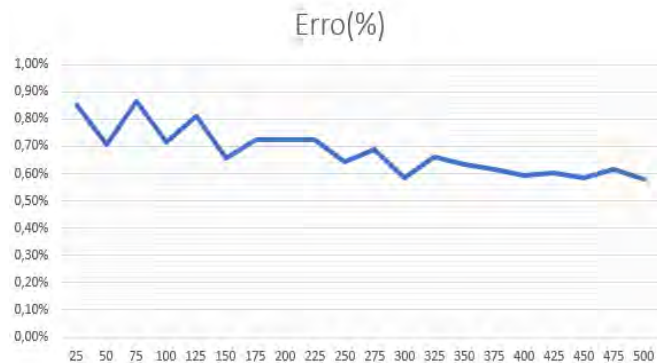
Figura 2 - Gráfico do erro de medição de velocidade em diferentes pontos de velocidade.
