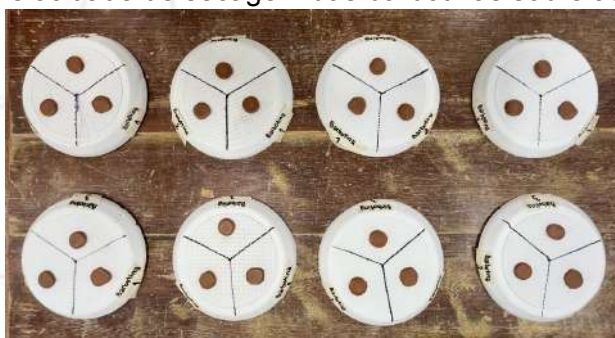
Figura 1 – Teste de velocidade de secagem das barbotinas sobre as amostras de gessos
