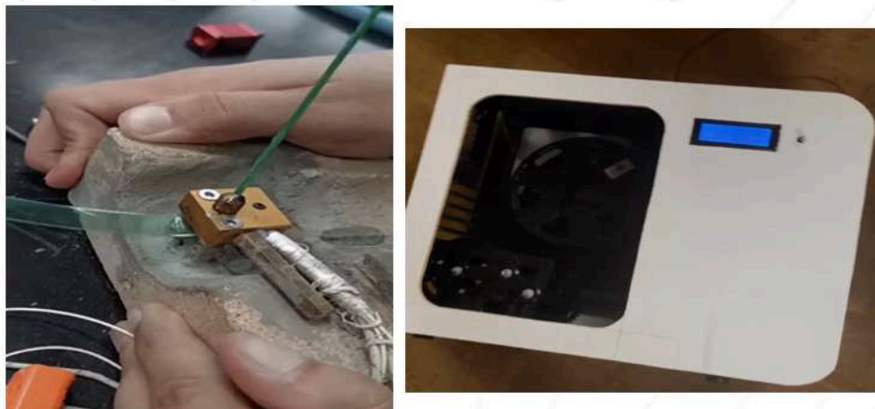
Figura 2 – Extrusão do filamento (a) e – Extrusora montada (b)
