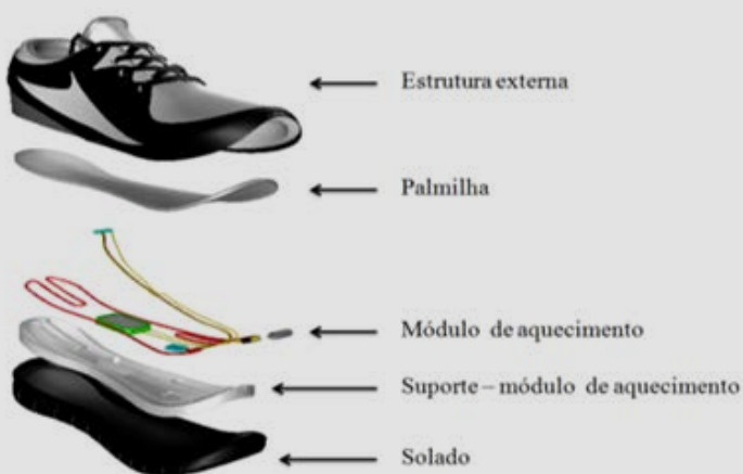
Figura 7: Vista explodida da montagem do produto
