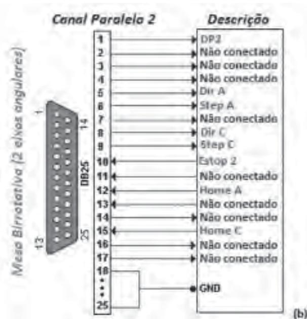
Figura 6 - Configuração das portas paralelas do PC
