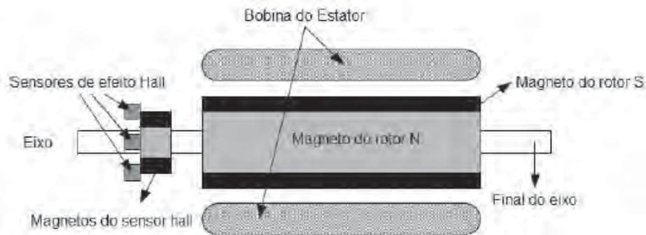
Figura 1 – Concepção mecânica de um motor BLDC.
