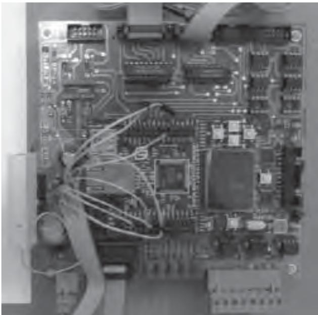
Figura 6 – Plataforma de avaliação e desenvolvimento com o microcontrolador LM3S8962.
