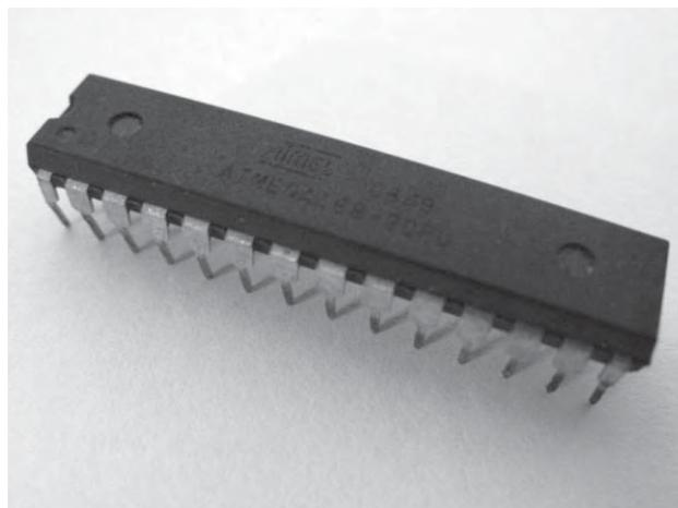
Figura 1 – O microcontrolador ATmega168.
