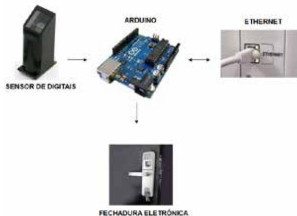
Fig.1 – Partes que compõem o sistema
