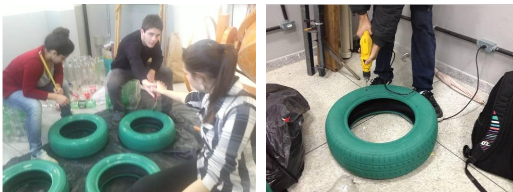
Figura 06 – Pintura dos pufes de pneus e furos realizados com furadeira para colocação dos parafusos.
