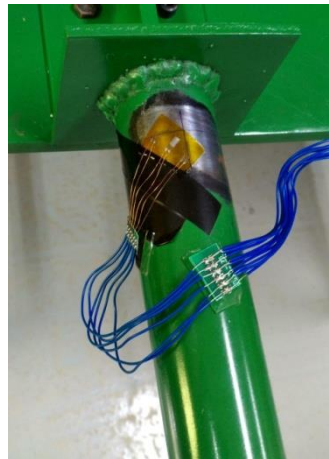
Figura 3: Resultado da colagem do extensômetro roseta triaxial na estrutura de flexão-torção.
