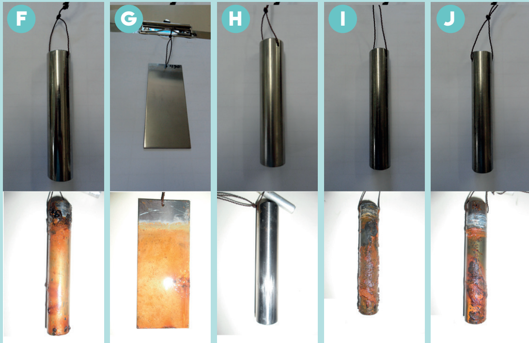
Figura 1b - Metais antes da imersão na água salgada e após 7 (sete) meses de experimento
