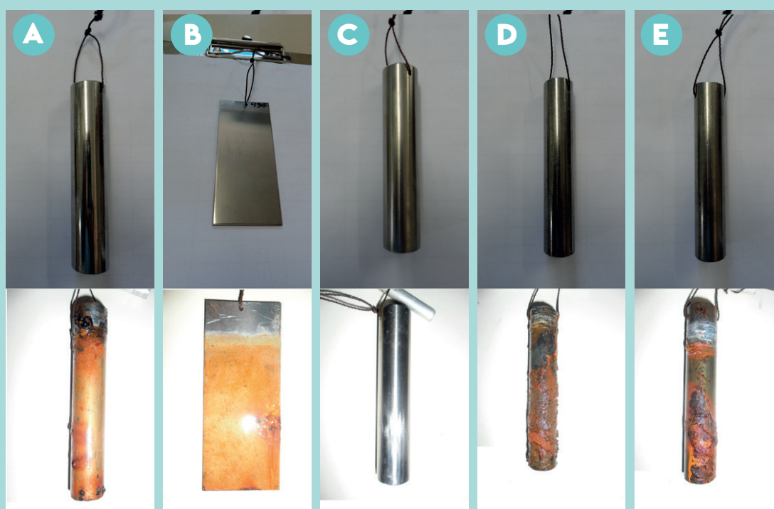
Figura 1a - Metais antes da imersão na água salgada e após 7 (sete) meses de experimento
