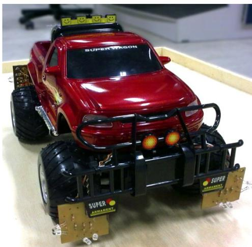
A caminhonete de controle remoto é constituída por dois motores de corrente contínua, um para controlar a direção das rodas dianteiras (direita e esquerda) e outro para controlar as rodas traseiras (seguir em frente ou recuar, dar a ré).
