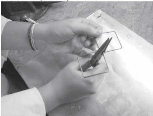
FIGURA 2 — Medida dos lados da antena bi quadrática feita de cobre
