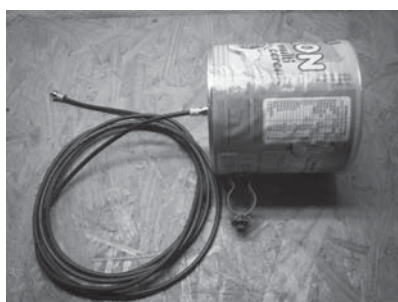
FIGURA 1 — Antena wireless construída
