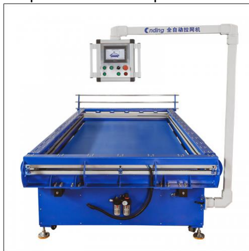
Figura 2 - Máquina automática para esticar e colar telas
