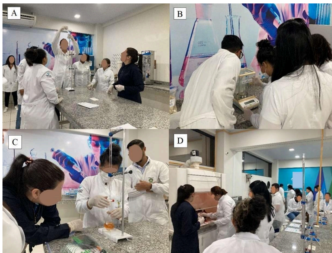
Figura 4 – Análise físico-química do óleo de castanha da Amazônia: (A) preparo de bureta para titulação, (B) pesagem das amostras, (C) titulação, (D) preparo de soluções em capela.
