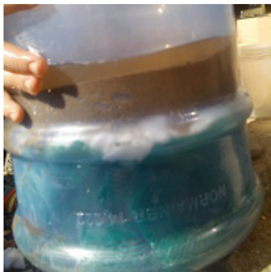
Figura 2: Filtro caseiro montado.
