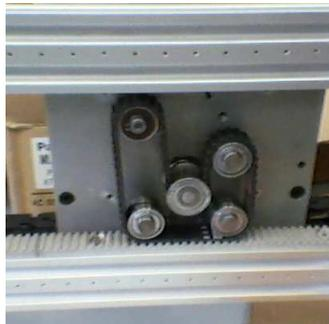
**Figura 5:** Foto do sistema de transmissão de movimento do eixo X.
